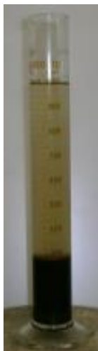
Směs z aktivace po 30min sedimentace cca 30-40% kalu - optimální stav
