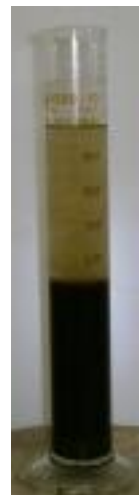
Směs z aktivace po 30min sedimentace cca 60% kalu – je potřeba redukovat kal v ČOV
